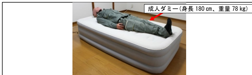
写真 4. 成人ダミーをベッド上面の中央に仰向けに寝かせた状態
